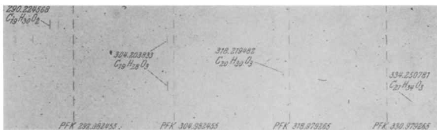
Abb. 2. Ausschnitt aus einem Photoplattenspektrum. Das Spektrum zeigt den Molekülionbereich mehrerer im Gaschromatogramm getrennter Fraktionen
